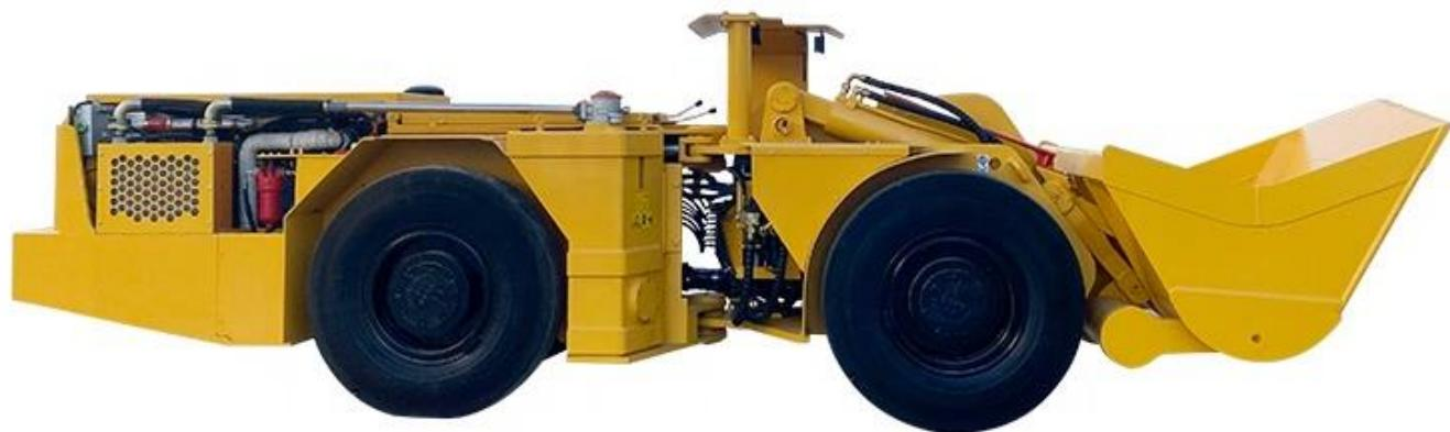
DALI WJ-2 es un Load Haul Dump (LHD) compacto y liviano para minería de vetas estrechas. La mejor relación entre carga útil y peso propio de su clase. Es un Scooptram especialmente diseñado con un cucharón de 2 metros cúbicos y una carga útil de 4 toneladas para pequeñas minas subterráneas. WJ-2 tiene un brazo alargado, que aumenta la altura de descarga para que pueda coincidir con el volquete grande.
